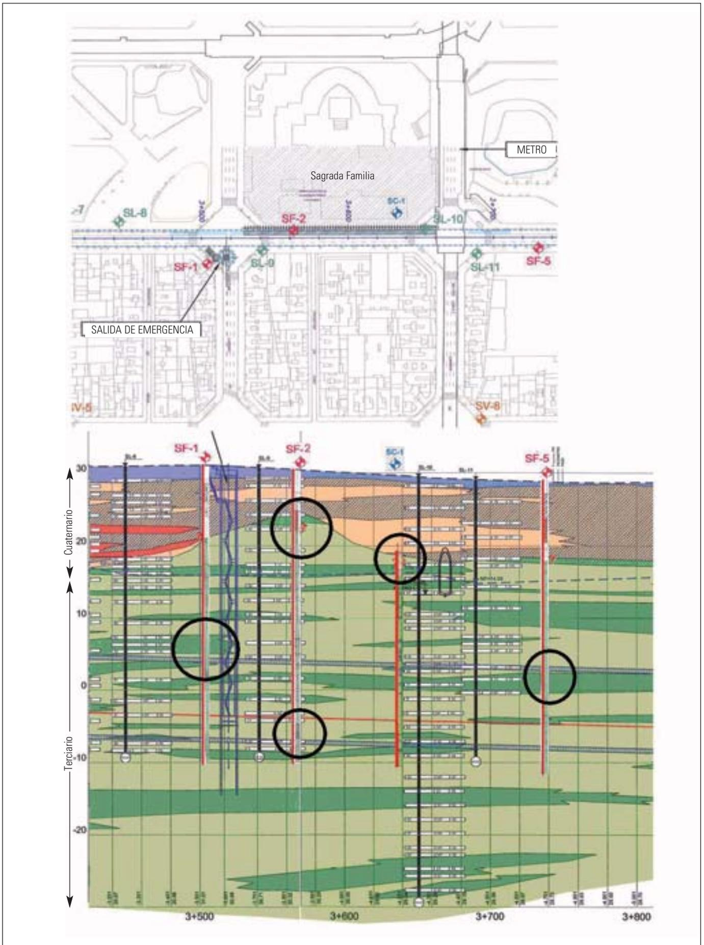
Figura 4. Situación en planta de los sondeos disponibles y perfil geológico con los sondeos SF-1, SF-2 y SF-5. Los círculos negros señalan las zonas donde se han detectado incertidumbres entre el perfil y los registros de sondeos.
