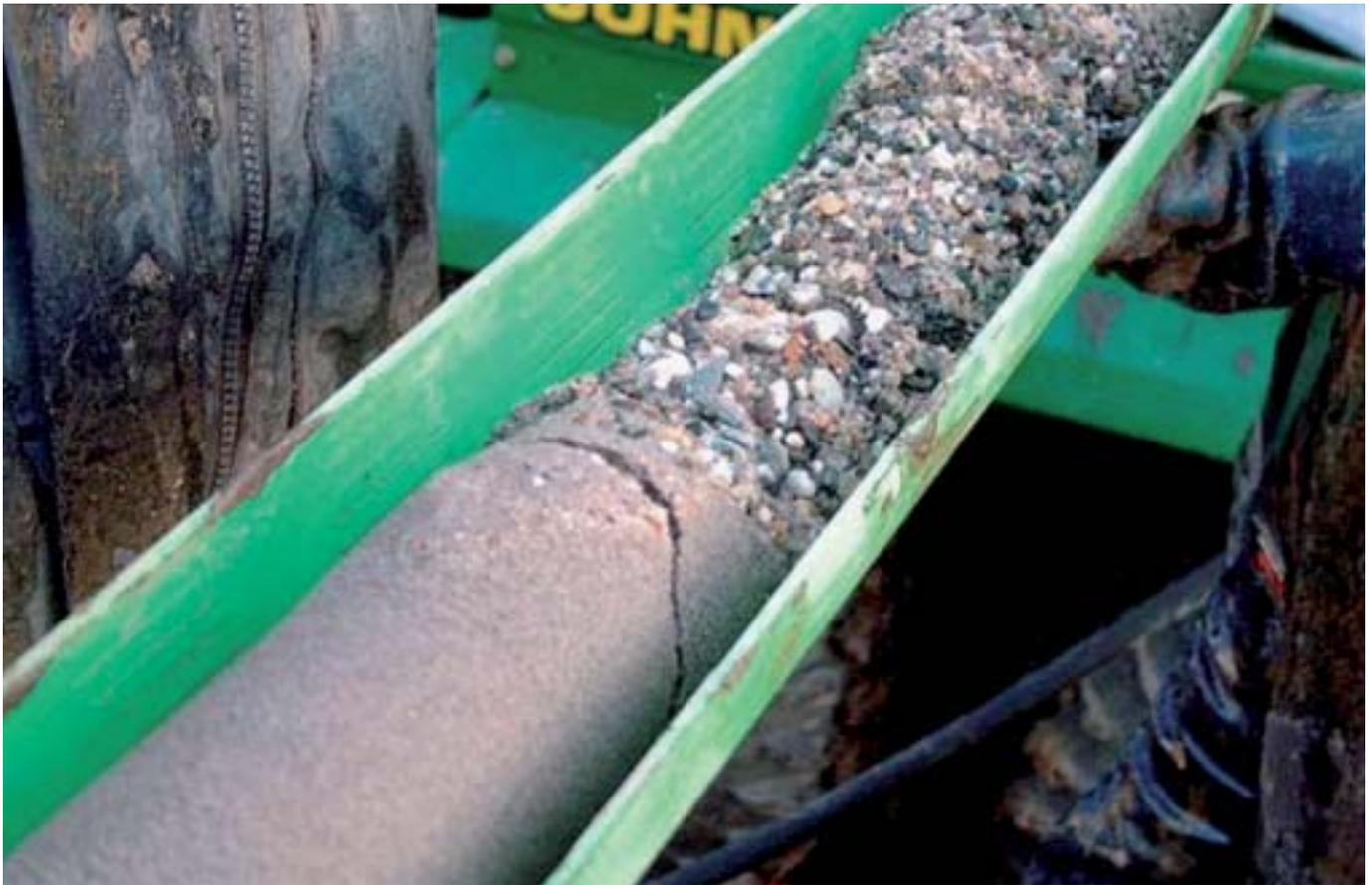
Figura 1. Muestra de testigo continuo en sondeo, obtenida con Aqualock®.
